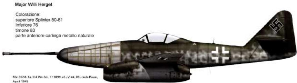
Questa versione speciale del Me 262 costruita in 2 prototipi utilizzati dallo JV44 montava al posto del normale armamento di 4 mk 108 un cannone da 50 mm mk 214 o Bk 5 (Bordkanone 5) in funzione anti tank il primo e anti bombardiere il secondo.
