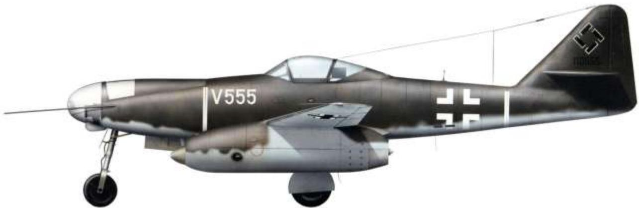
Versione da bombardamento del jet con aviere puntatore alloggiato nel muso anteriore ridisegnato vetrato. Alla fine di novembre del 1944 arrivò all'aeroporto di Lechfeld il primo prototipo(V484) seguito in gennaio del 1945 (V555) senza cannoncini e con un carico utile di 2 bombe da 250Kg o una da 500Kg. I collaudatori Karl Bauer e Gerd Lindner trovarono molto soddisfacenti le caratteristiche del modello anche se il puntatore era abbastanza esposto ai colpi nel muso vetrato.
