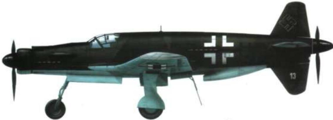
Do 335M13(B-2) (W.Nr. 230013), камуфляж RLM 81/82/65. Оконцовки крыльев не окрашены, пропалеваны RLM 02. На нижней стороне крыльев кресты шириной 1525 мм, на бортах фюзеляжа 1250 мм.
